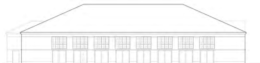
Sydfacade med nye fløjddøre i stueetagen
